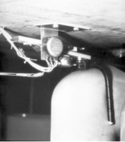
Abbildung 41. Experimentelles Eingabegerät, das mit dem Knie zu bedienen war
