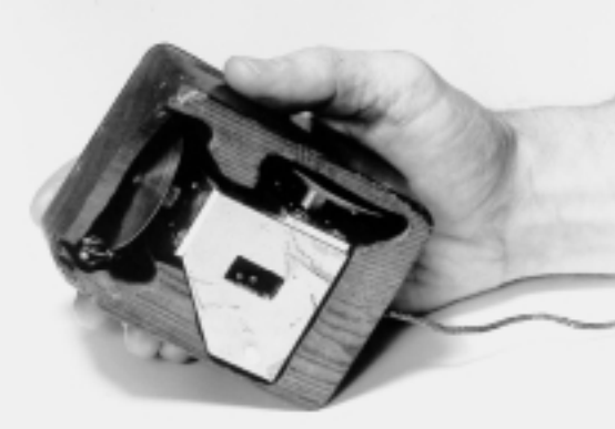
Abbildung 43. Erste von William K. English konstruierte Maus aus dem Jahre 1964 (abgedruckt mit Genehmigung von SRI International)
