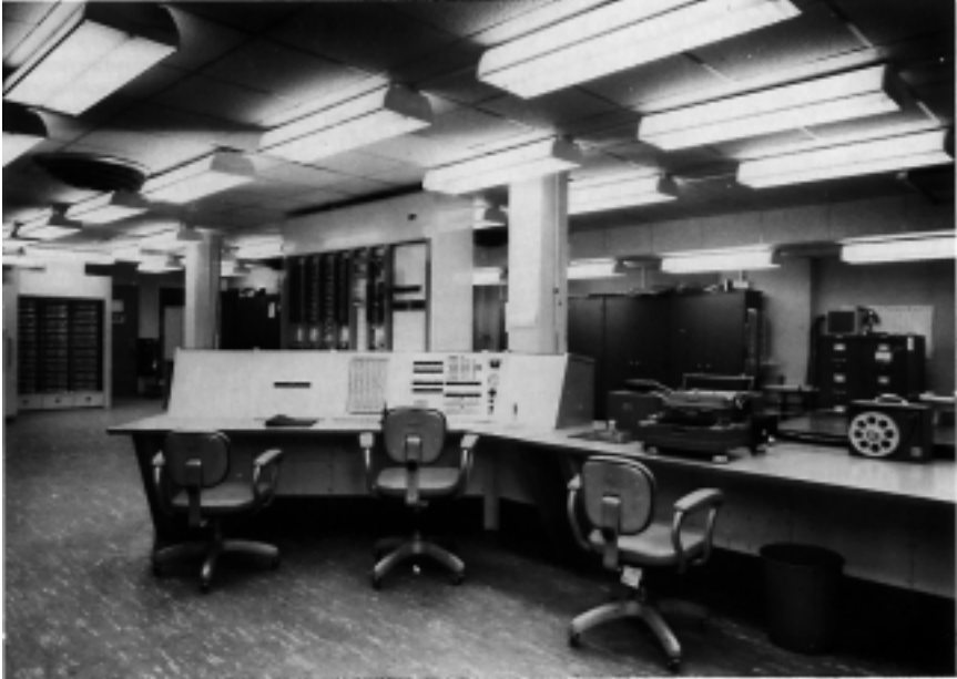
Abbildung 25. TX-0 und TX-2 Computer (um 1958). Auf der rechten Seite des Bedienpults ist ein Flexowriter zu erkennen.
