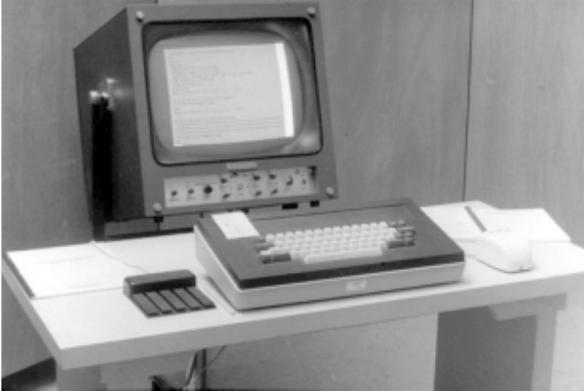
Abbildung 46. Einfaches Terminal für das Online-System, bestehend aus Bildschirm, Einhand- und Schreibmaschinentastatur sowie der ersten in Kleinserie gefertigten Maus, um 1968.
