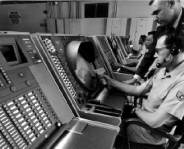
Abbildung 23. Operator mit Lightgun an einem SAGE-Bildschirmterminal
