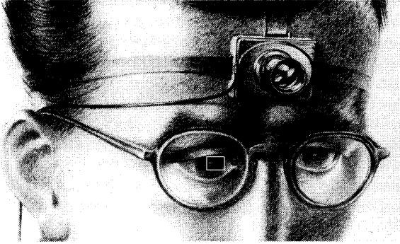
Abbildung 5. Wissenschaftler mit der Zyklophenkamera. Das weiße Rechteck kennzeichnet das in die Brille eingebaute Sucherfeld.
