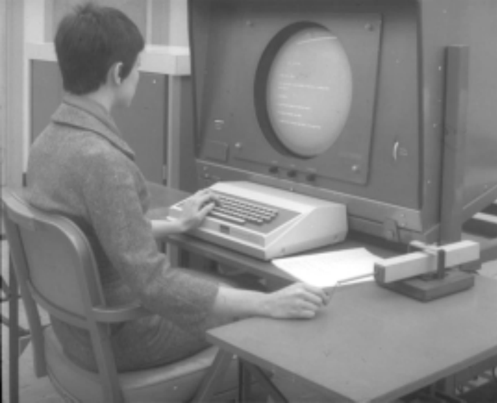
Abbildung 40. Bildschirmarbeitsplatz, an dem 1963/64 die Experimente mit unterschiedlichen Eingabegeräten durchgeführt wurden. Rechts im Bild ist das Grafacon zu sehen.
